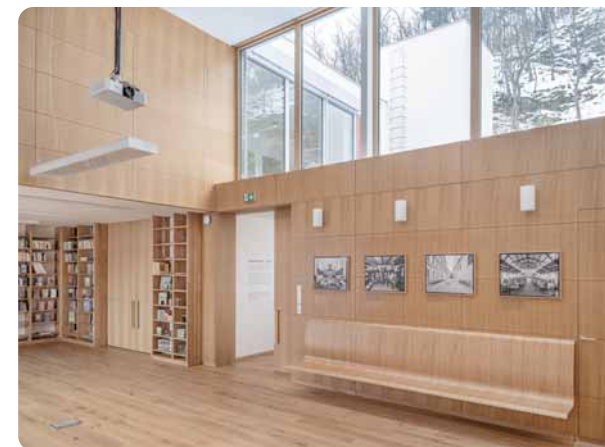
↑ Vzhledem k severní orientaci uliční fasády a svahu za domem je sluneční světlo přiváděno do sálu shora, velkorysým světlíkem
