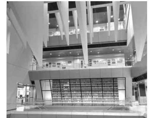
Světlovody vedou z koruny knihovny a zajišťují dostatek světla i v případě výpadku elektřiny
