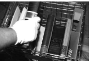
Umístění knih do speciálních košů před vložením do technologie odkyselování Papersave Swiss
